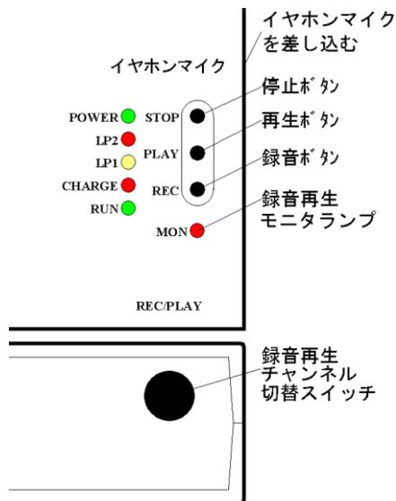
1. 最初に録音するチャンネルを「録音再生チャンネル切替スイッチ」で選択します。手でチャンネルつまみを回して下さい。見えている番号が現在のチャンネルになります。(スイッチカバーが無い場合は、小さいマイナスドライバーで回して下さい。矢印の指している番号が現在のチャンネルになります。)
