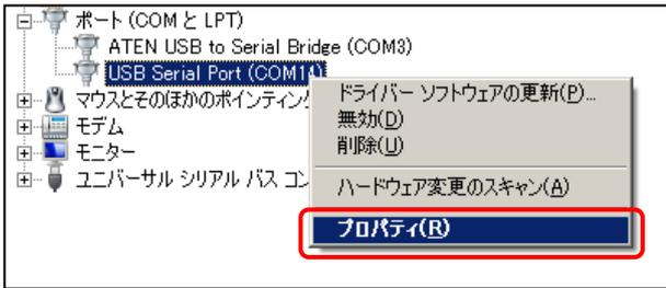
「USB Serial Port のプロパティ」の「ポートの設定」タブをクリックし、「詳細設定」を開きます。
