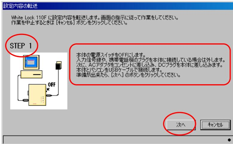
「STEP1」画面に表示される説明に従って AC アダプタを接続し、「次へ」のボタンをクリックします。
