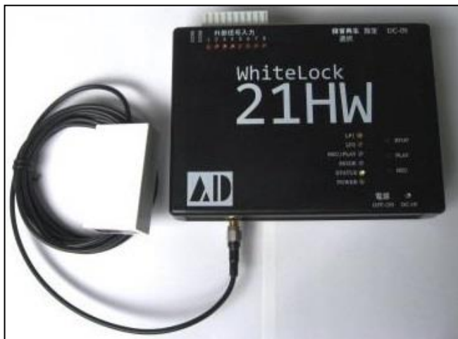
「小型防滴アンテナ」 外形寸法 60 × 35 × 20mm 同軸ケーブル長 約 2.5m 使用温度 -20～90℃
