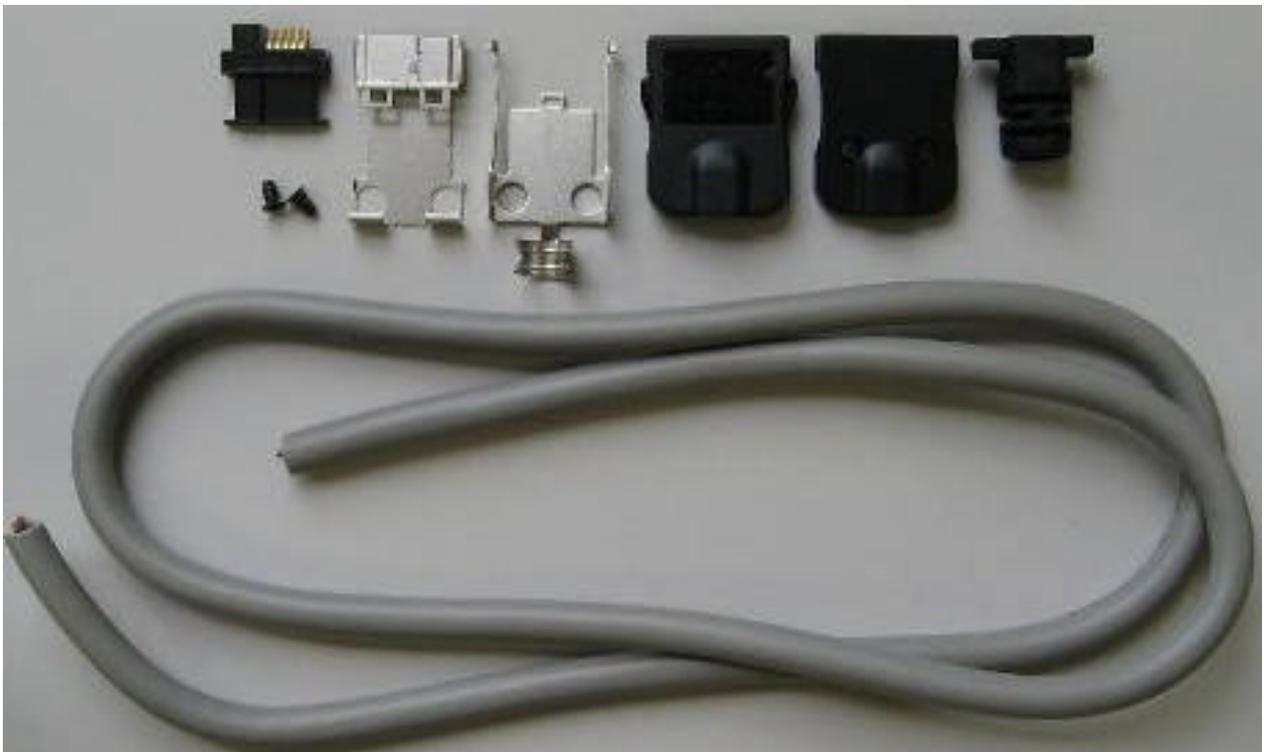
携帯ケーブルの組立が完成しましたら、導通検査をして、ケーブル端を「Unit01\_Testボード」のCN1へ接続します。ケーブルはCN1の横の基板穴に部品面からリード線を差し込んでハンダ面の該当する端子ピンへ半田付けします。接続端子位置は、FOMA\_USB\_Unit01の取扱説明書をご覧ください。
