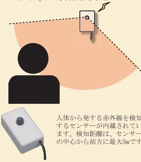
人体から発する赤外線を検知するセンサーが内蔵されています。検知距離は、センサーの中心から前方に最大5mです。
