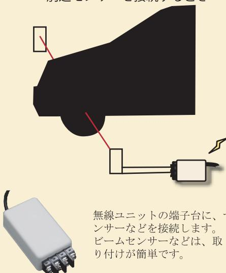
無線ユニットの端子台に、センサーなどを接続します。ビームセンサーなどは、取り付けが簡単です。
