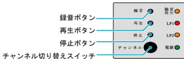
1. 最初に録音するチャンネルを「チャンネル切り替えスイッチ」で選択します。スイッチを録音したいチャンネルにあわせませす。小さいマイナス、プラスドライバーで回してください。矢印の指している番号が現在のチャンネルになります。
