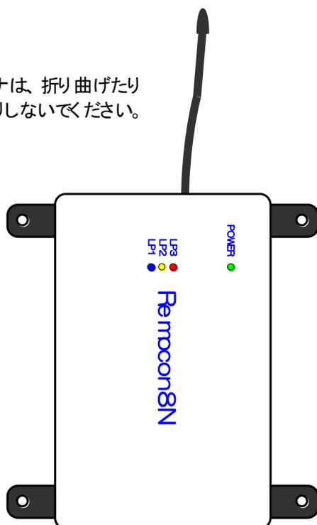
本体は、電波を遮蔽するような、鉄板、アルミニウム板、ステンレス板等から 40 センチメートル以上離して取り付けて下さい。また、これらの材料で作られたケース内には入れないで下さい。
