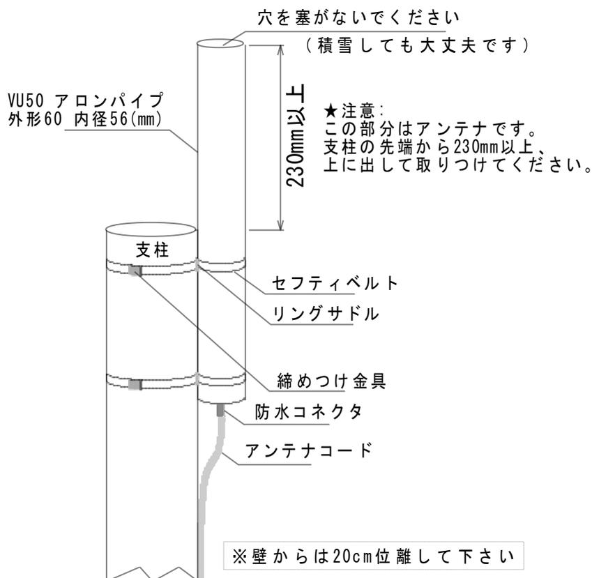
※中継機アンテナは寒暖差が発生しないよう外筒と中筒に空間を作り空気が上昇するような構造となっています。空間に枯葉などの異物がありますと空気の上昇が上手くできない可能性があり、中筒内部に湿気がこもる要因となります。中筒内部に湿気がこもりますと内部部品が劣化する恐れがありますので、外筒と中筒の間に入った枯葉などの異物は定期的に排除してください。
